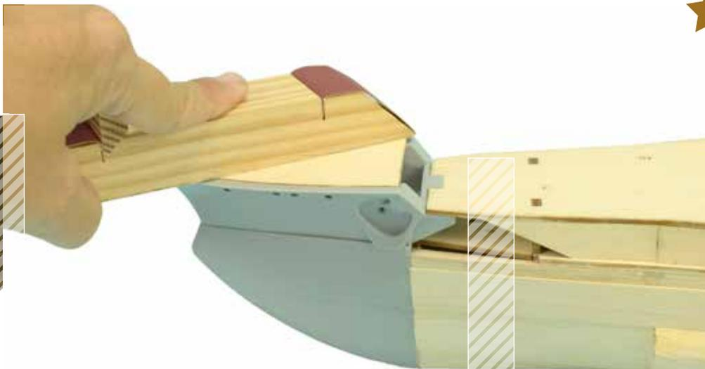
4. Используйте шлифовальный брусок, чтобы сделать поверхность палубы идеально ровной, сравнивая деревянную и пластиковые поверхности.
