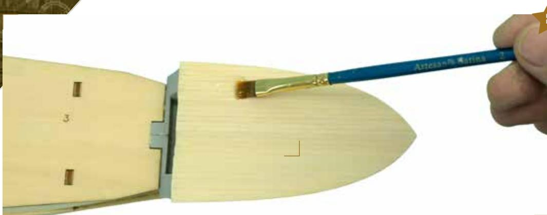
**8.** Нанесите два слоя сатинового лака, чтобы укрепить палубу. Дайте каждому слою хорошо высохнуть перед нанесением следующего.
